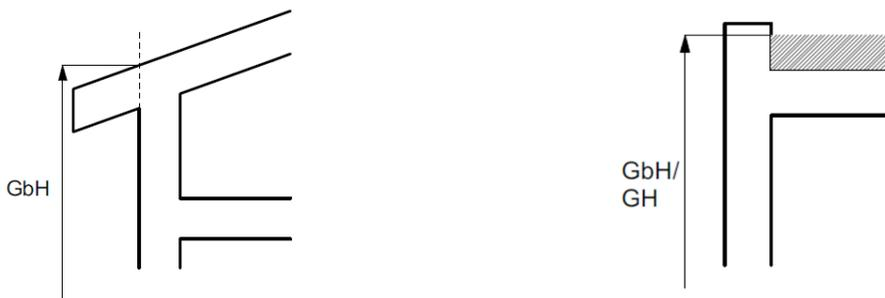
Schnittpunkt Fassade-Dachoberkante bei Satteldach – auf Höhe Oberkant der Dach-eindeckung
